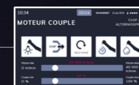
MOTEUR MX À INDUCTION Affichage et présélection de la vitesse des micro-moteurs. Réglage du couple et fonctions auto-reverse et auto-forward. MX INDUCTION MOTOR Micromotor speed display and preselection. Torque adjustment, and auto-reverse and auto-forward functions.
